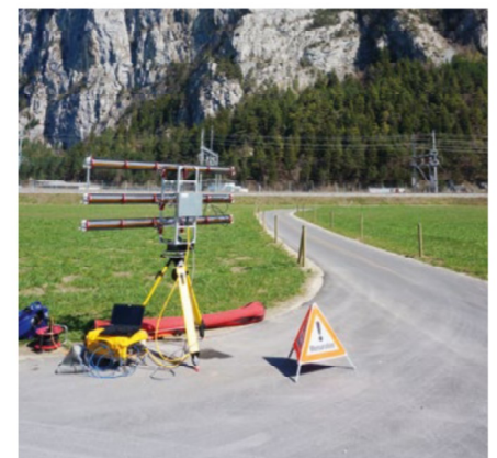
9: Georadar im Einsatz zur Überwachung der Zufahrtstrecke zum SBB Gotthard-Basistunnel Quelle: Rafael Caduff, GAMMA Remote Sensing AG
