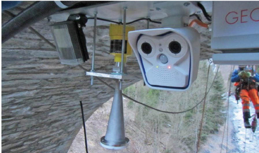
8: Pegelsensor und Kamera zur Kontrolle des Carrerabachs 1,4 km oberhalb der Bahnbrücke Quelle: Rhätische Bahn
